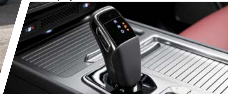
8-biegowa automatyczna skrzynia biegów: Shift-by-wire
